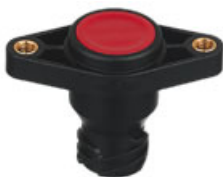
ECSW70 Fjädrande knapp (impuls) Sluten krets nedtryckt Bruten krets viloläge
