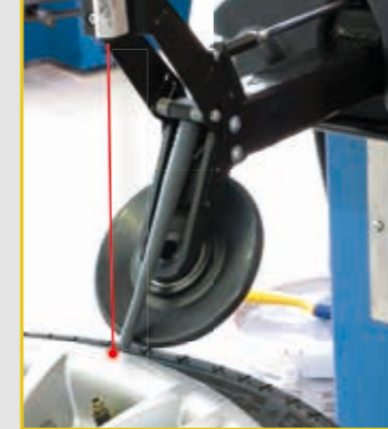
En laserstråle styr rullarnas korrekta placering
