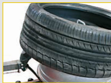
Vulstbrytning utförs snabbt på båda sidor
