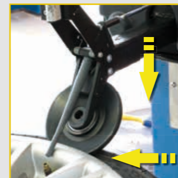
En sensor aktiverar automatiskt vulstbrytaren, som arbetar i rätt position och inte på fälgsidan
