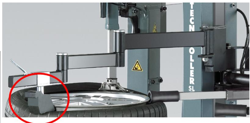
6. 3-Fach Hülse von der Abdrückschaufel demontieren. Dazu mit einem Dorn den Arretierstift austreiben. (evtl. muß die Welle leicht gedreht werden)
