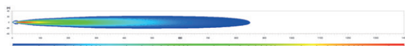
Flodreflektorn ger en bredare men också lång ljusbild. Ljusslängd vid 1 lux: 850 meter.
