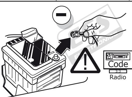
(DE) Um Störungen und Schäden am Bordnetz zu vermeiden, muss die Massepolklemme unbedingt vor Beginn aller Arbeiten von der Fahrzeugbatterie getrennt werden! Insbesondere bei Arbeiten und Anschlüssen am CAN-Datenbus kann bei nicht abgeklemmter Batterie sowohl das Anhängermodul als auch das fahrzeugseitige Bordnetzsteuergerät beschädigt werden! Bitte Herstellervorschriften beim Ab- und Anklemmen der Fahrzeugbatterie beachten!
