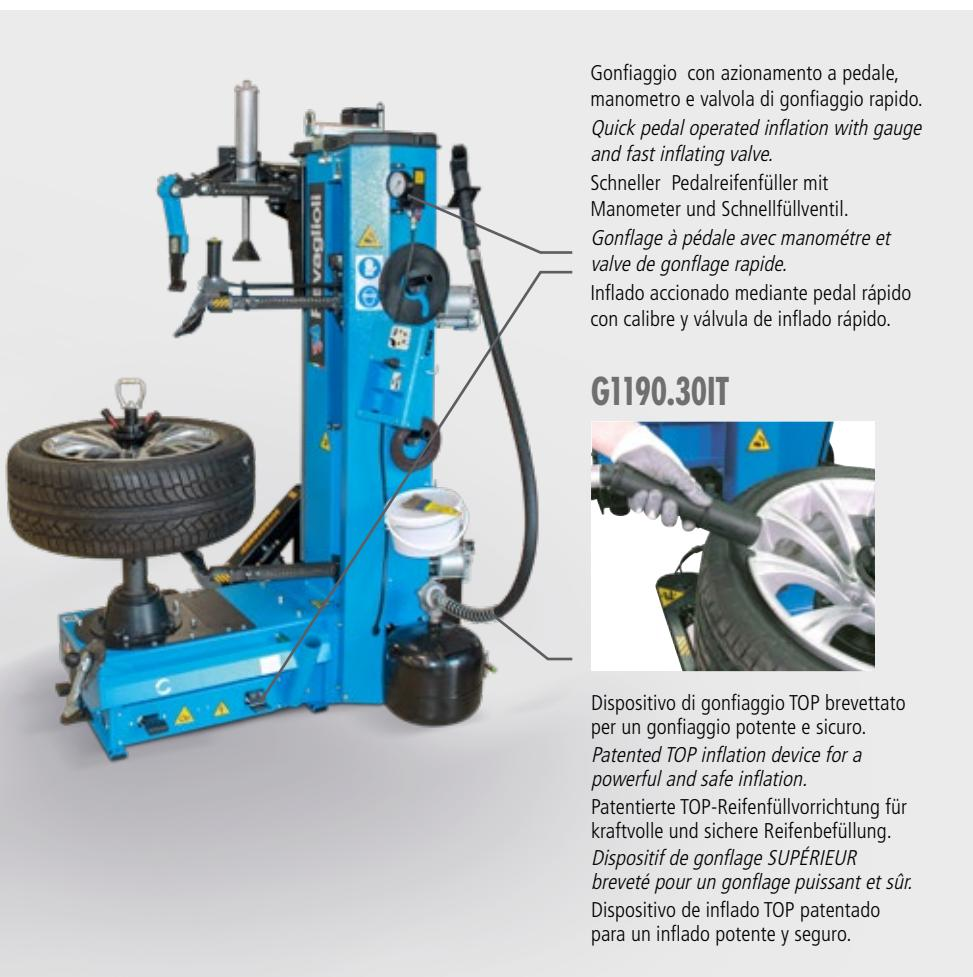
Gonfiaggio con azionamento a pedale, manometro e valvola di gonfiaggio rapido.
