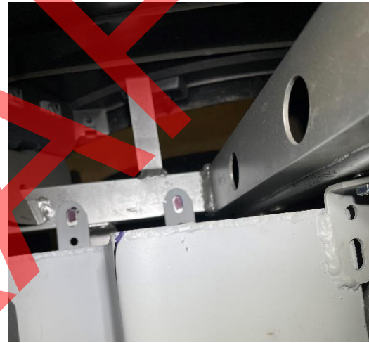
Markera för att borra 2 st 6mm hål
