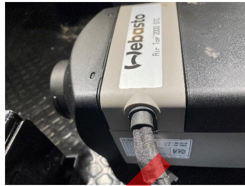
Tryck fast locket, Säkerställ att gummitätning samt lock sitter korrekt.
