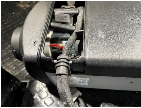
Tryck fast kontaktstycket, fäster i ett spår. Led led ut kabelstam enligt bild.
