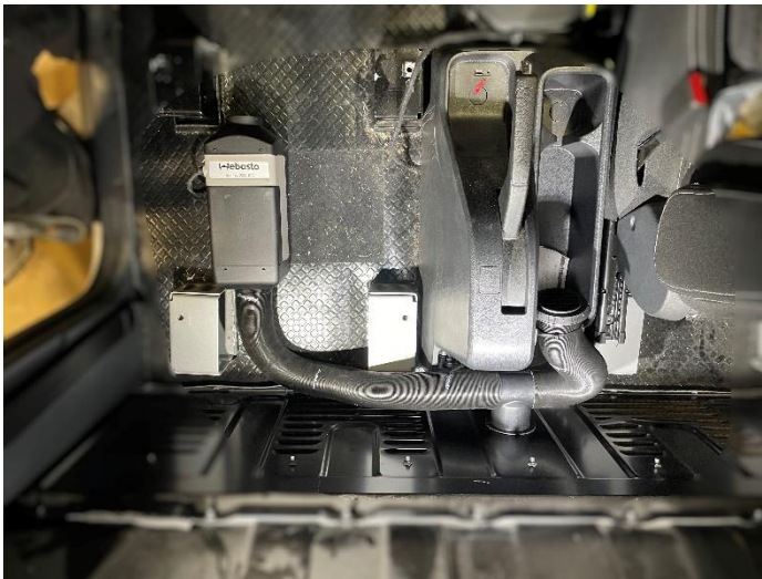
Slangdragnings utförande på provmonterad bil.
