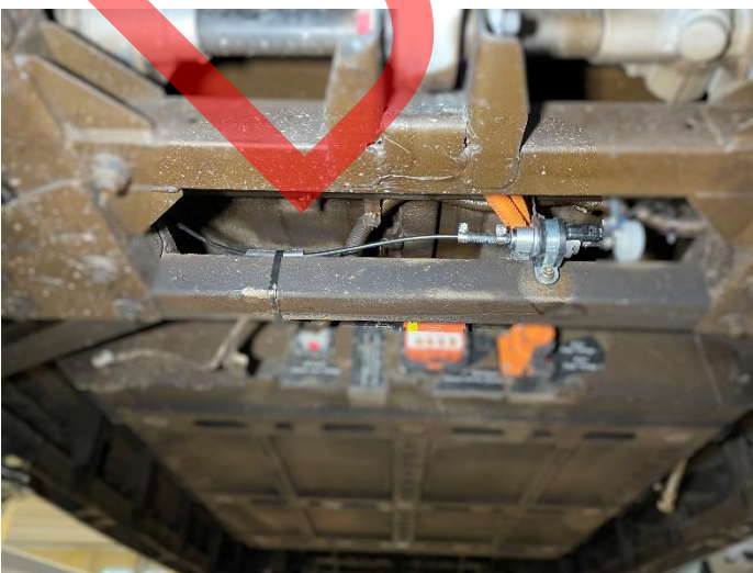
Fortsätt med bränsleledning mot tanken, följ bromsledningar upp i motorrum. (se även bild nedanför)
