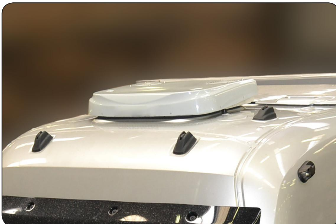
Fijar el aire acondicionado utilizando los soportes **B**: introducir los extremos de los soportes bajo el revestimiento de tal manera que se sostengan las partes metálicas; introducir los tornillos **CC** con las arandelas **DD** y las tuercas **EE** y atornillar en los casquillos roscados situados al fondo del aire acondicionado. Aplicar tensión y apretar las tuercas **EE** contra los soportes **B**.
