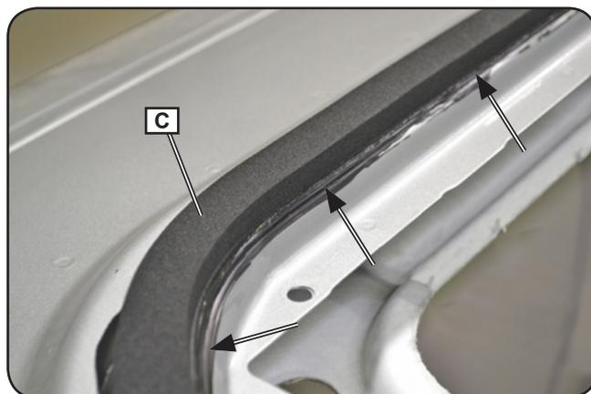
Introduire le câblage d'alimentation dans l'espace situé entre le toit et le revêtement sur le pare-brise puis le diriger vers les points d'alimentation présent à l'avant du véhicule. **NB** : dans le cas où il serait nécessaire de prolonger le câblage électrique, utiliser un câble d'alimentation de section supérieure à celle du câble fourni et le protéger au moyen d'un fusible.
