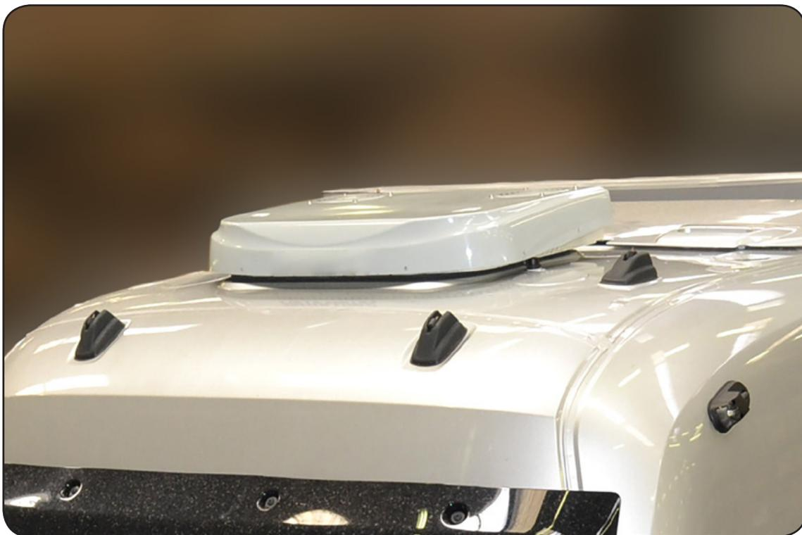
Die Klimaanlage mit den Bügeln **B** befestigen: die Enden der Bügel unter der Verkleidung anbringen, so dass sie auf den metallischen Teilen Halt finden; die Schrauben **CC** mit den Scheiben **DD** und den Muttern **EE** einsetzen und in den Gewindebuchsen am Boden der Klimaanlage verschrauben. Auf Spannung bringen und die Muttern **EE** auf den Bügeln **B** anziehen.
