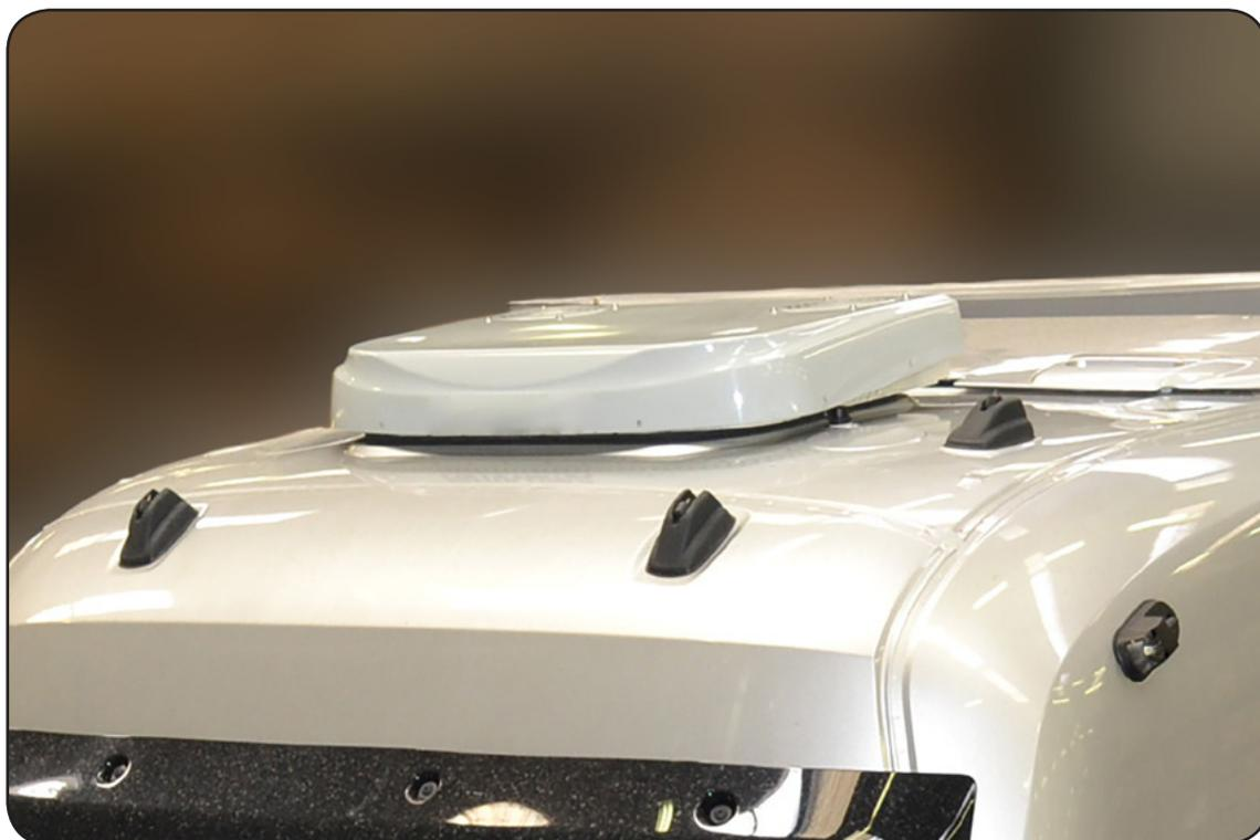
Fissare il condizionatore utilizzando le staffe **B**: inserire le estremità delle staffe sotto al rivestimento in modo tale da fare presa sulle parti metalliche; inserire le viti **CC** con le rondelle **DD** e i dadi **EE** e avvitare nelle boccole filettate poste sul fondo del condizionatore. Portare in tensione quindi serrare i dadi **EE** contro le staffe **B**.
