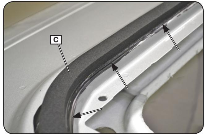
Die Versorgungsverkabelung in den Zwischenraum zwischen Dach und Verkleidung über der Frontscheibe einführen und zum Bereich der Elektroversorgung führen, die sich an der Fahrzeugfront befinden. **ANMERKUNG:** falls eine Verlängerung der elektrischen Verkabelung notwendig ist, ein Versorgungskabel mit größerem Querschnitt als den beiliegenden verwenden und mittels einer Sicherung schützen.
