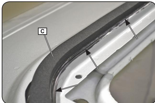
Introducir el cableado de alimentación en el hueco entre el techo y el revestimiento sobre el parabrisas, y dirigirlos hacia los puntos de alimentación situados en la parte delantera del vehículo. **Nota:** si es necesario prolongar el cableado eléctrico, utilizar un cable de alimentación con mayor sección que el suministrado y protegerlo mediante un fusible.
