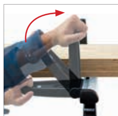
Tiltfunktionen förenklar lastning och avlastning.
