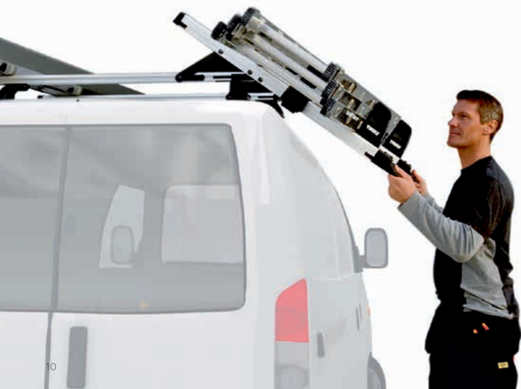
Bara att fälla ner lasthållaren och lasta på stegen.
