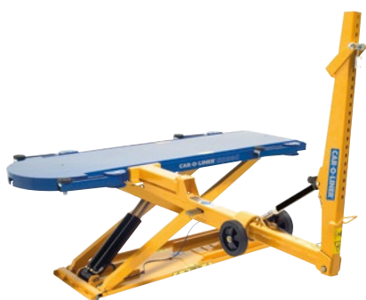
Speeds D20 dragriktare ger 5-ton dragkraft från sidan med D201 sidofästen (tillval)
