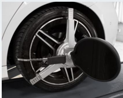
I target con obiettivo 3D installati sulle griffe sono estremamente leggeri, esenti da manutenzione e senza componenti elettronici. Rilevano in pochi secondi tutti gli angoli del veicolo senza interventi da parte dell'operatore.
