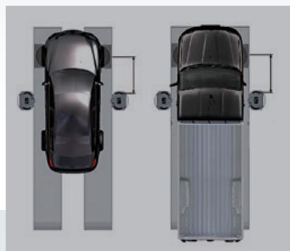
Unica posizione d'installazione delle teste per la misurazione di veicoli con passo differente.
