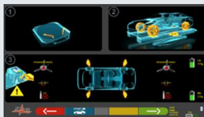
Banca dati internazionale con schede tecniche veicolo e possibilità di creare una banca dati clienti per la registrazione interventi. Software di gestione e visualizzazione, in ambiente Windows, sempre connesso con la chiave USB Wi-fi. Semplice ed intuitivo grazie ad una grafica ad alta risoluzione.
