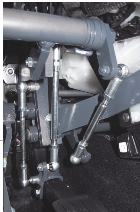
Stellung der Hebel und Schubstangen bei Rückholung des Gaspedals durch den Fahrlehrer
