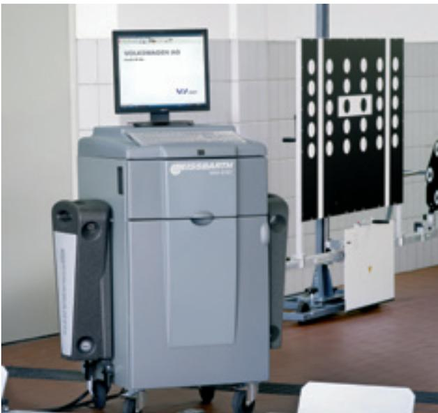
**Der mobile Fahrwagen trägt die beiden Messwertaufnehmer und hat Rechner und Drucker staubgeschützt im Schrank untergebracht.**
