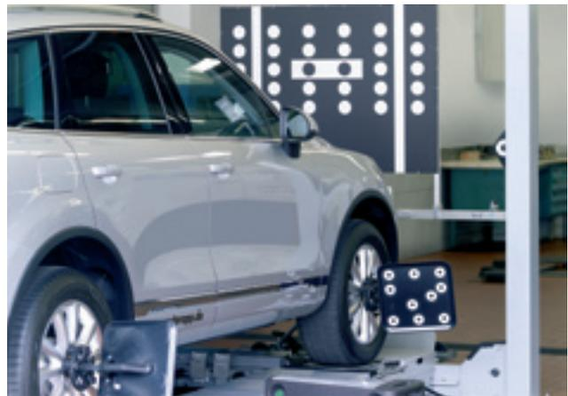
**Das neue VAS 6767 ist in Kombination mit der Justagevorrichtung für die ACC- und Spurhalteassistenten einsetzbar.**
