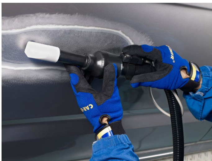
Krympering av stål och aluminium under reparation
