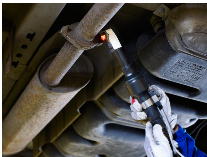
Värmning av bult och skruv på styrnings- och hjulupphängningsdelar
