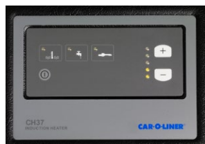
Enkel och tydlig kontrollpanel med styrenhet för fem effekt-nivåer
