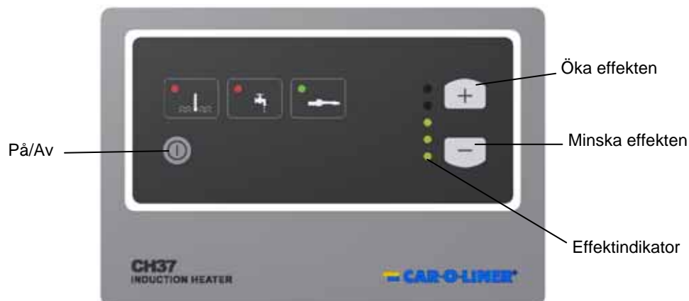
Figur 4.2 De viktigaste funktionerna på kontrollpanelen.
