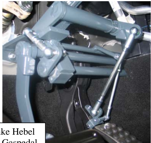
Ansicht bei Vollgasstellung. Das Gaspedal muss die Kick-Down-Stellung erreichen.
