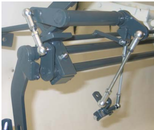
Ansicht der hebelstellung bei Standgasstellung.
