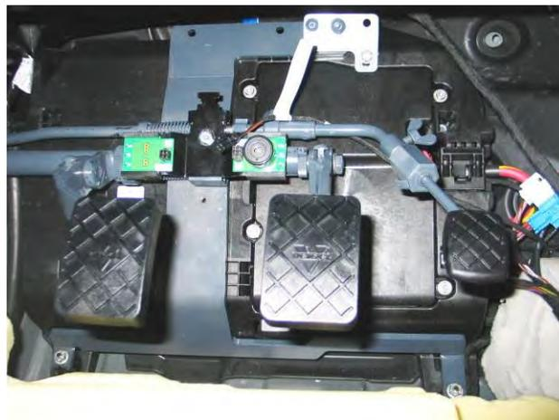
40. Kabelstrang auf die Platinen aufstecken. Die Kabel scheuerfrei verlegen und vorn mit einem Kabelbinder am Blech festbinden (Pfeil).
