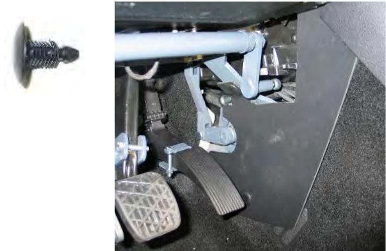
59. Doppelbedienung im Stand und bei einer Probefahrt auf Funktion prüfen. Hierbei noch einmal auf Leichtgängigkeit der Wellen sowie auf Freigängigkeit aller Hebel und Übertragungselemente achten.
