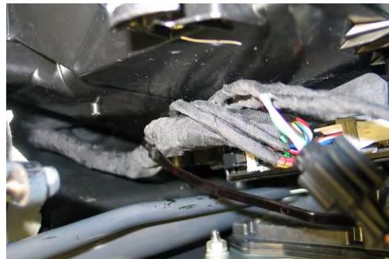
30. Mittelstück ganz einschieben und die linke Halterung oben an den Halter anlegen.
