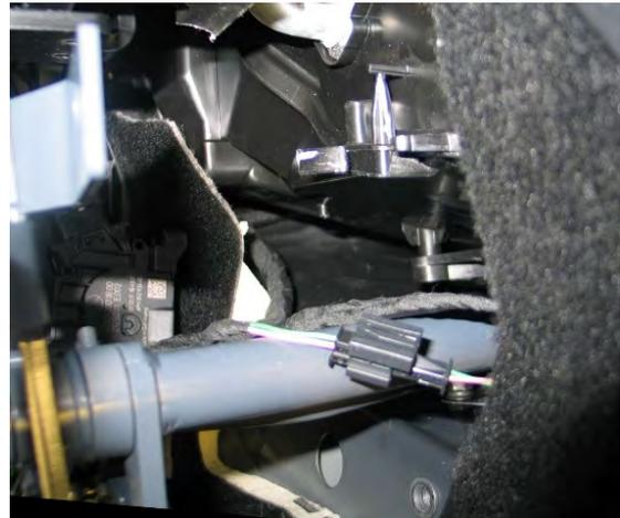
29. Die Kabel so weit wie möglich nach rechts drücken und vorn an den Befestigungspunkt des Steuergerätehalters mit einem Kabelbinder (Pfeil) festbinden.
