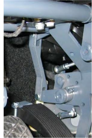
50. Die Stellschraube links in dem Haken so einstellen, dass am Fahrlehrerbremspedal noch ca. 1-2 mm Spiel vorhanden ist. Von rechts kräftig bremsen. Stellschraube bei Bedarf nachstellen. Stellschraube kontern.
