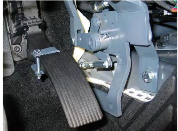
46. Am Bremsmitnehmer den Gewindestift M6 (Pfeil) so weit ausdrehen, dass er innen nicht übersteht. Mitnehmer für Bremse mit einer Kunststoffscheibe versehen und von rechts in den Schlitzhebel stecken. Mitnehmer von unten nach oben über den Originalpedalarm schieben und so festklemmen, dass der Schlitz keine seitliche Spannung zum Mitnehmer hat. Der Abstand des Bolzens zum oberen Schlitzende ist ca. 3-5 mm.
