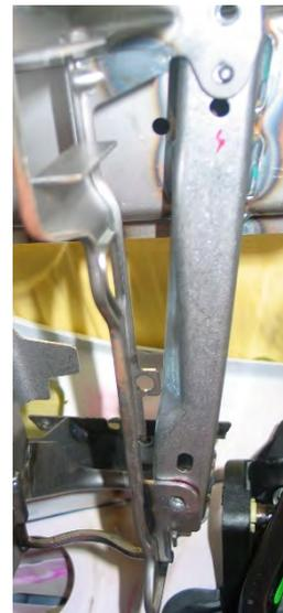
23. Hier den rechten Haltewinkel anlegen und mit den mitgelieferten Schrauben M8 x 30 festschrauben. Bei der A-Klasse wird der Halter mit der Nummer Z04187 verwendet, bei der B-Klasse der Halter mit der Nummer Z04221, (Siehe Seite 2 oben).
