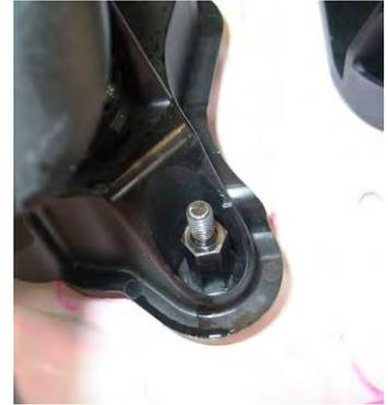
19. Die linke vordere Schraube M8 (Torx ,Pfeil) der Lenksäulenbefestigung abschrauben.
