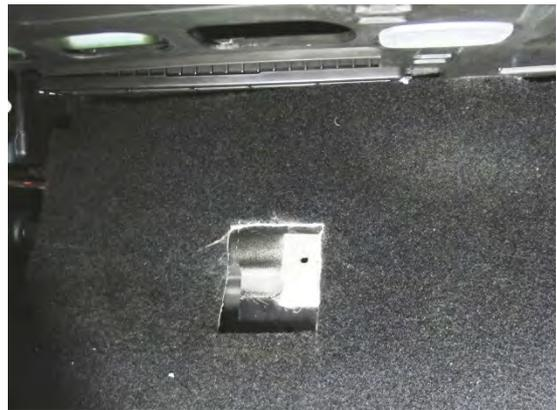
16. Am Tunnel links in die vorhandene Bohrung  $\varnothing$  11 mm eine Einnietmutter M8 einsetzen.
