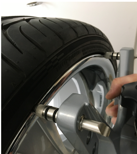
Gripansats på stål och aluminiumfälgar
