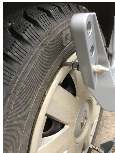
Lång gripsida vid monterade navkapslar
