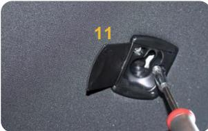
11. Haltevorrichtung für Gepäckraumnetz am Fahrzeughimmel abschrauben (2 Schrauben)
