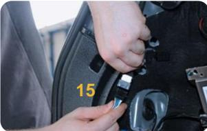
15. Stecker des Powerise-Antriebs von der Steckerverbindung lösen
