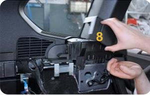
8. Verkleidung des Gurtstraffers entnehmen um darunterliegende Schraube zu lösen
