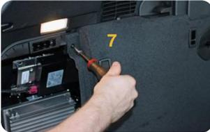
7. Um die Kofferraumverkleidung auszubauen zunächst die Verschraubung der Kofferraumverkleidung lösen (2 Schrauben und 3 Clipse), weiterhin Verkleidung für Fanghaken der Rücksitzbank ausbauen
