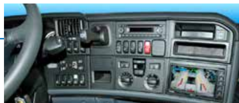
Exempel på en integrerad skärm med tillkopplad MXN-kamera via backkamerainterface.
