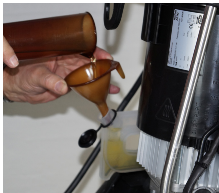
Pumpens oljetank har oljenivåglas och smart töm/fyll-funktion.
