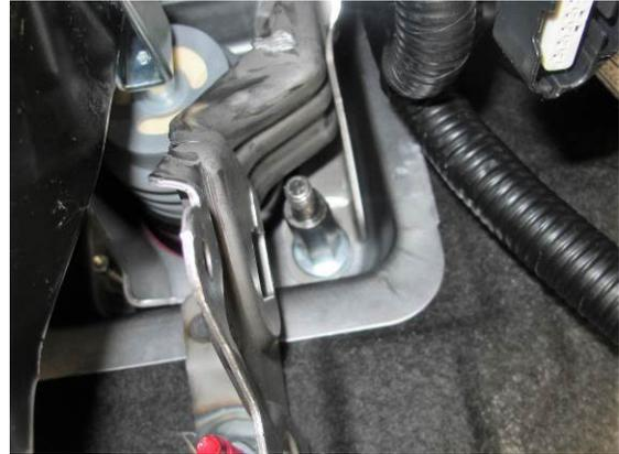
8. Die rechte Mutter an der Kupplungspedalkonsole abschrauben und den kurzen Stehbolzen (32mm) aufschrauben.
