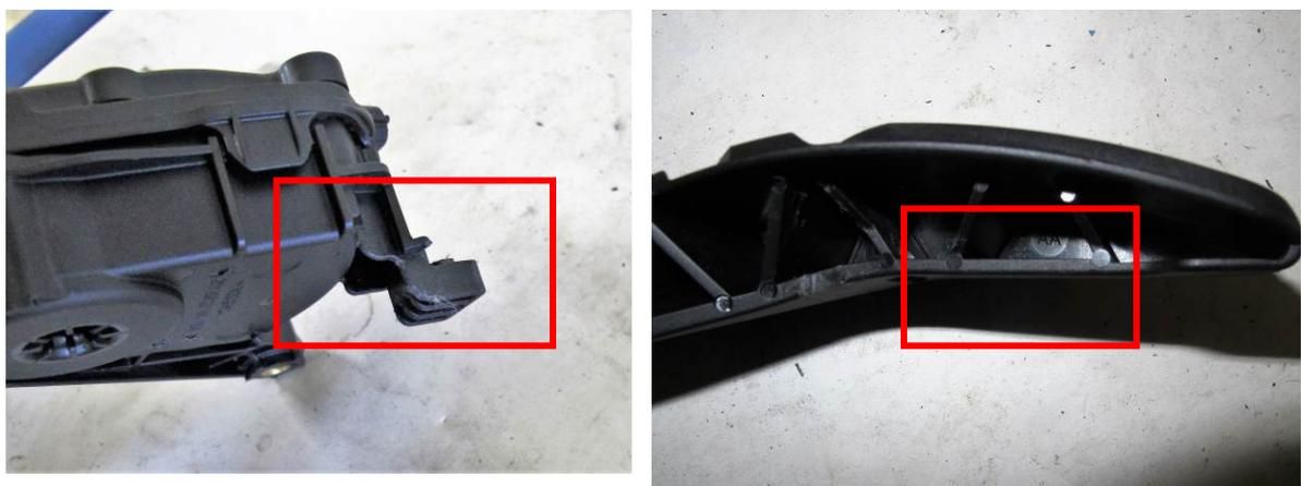
13. Gasmitnehmer ca. 40mm über der Pedalunterkante positionieren und mit  $\varnothing 5,5\text{mm}$  bohren. Den Gasmitnehmer noch nicht anschrauben.
