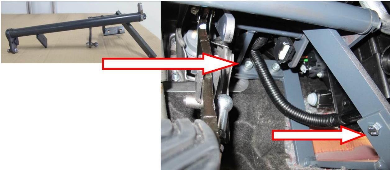
12. Am Gaspedal die Haltenase seitlich etwas abschleifen und am Pedalarm die Kante ca. 1 mm kürzen (der Pedalarm wird ca. 1 mm schmaler).
