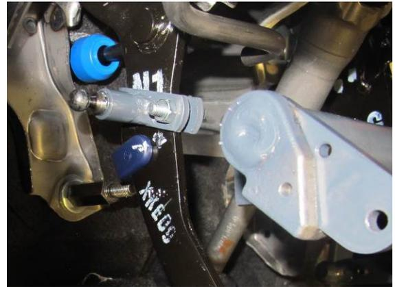
32. Mitnehmer für Bremse an der Verjüngung über den Pedalarm schieben und ca. 50mm über der Pedalplattenoberkante positionieren und festklemmen. Danach die Madenschraube festziehen.
