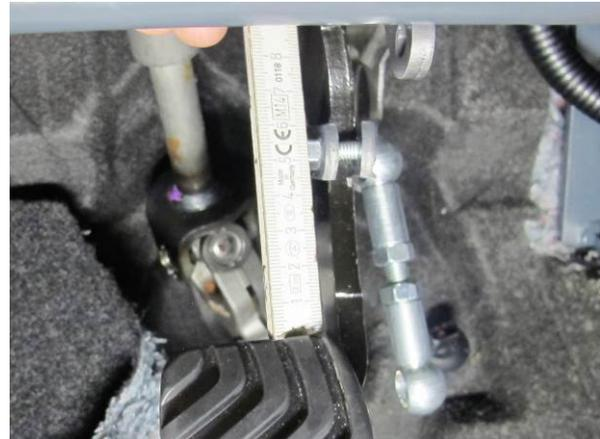
33. Die linken und mittleren Schubstangen für Kupplung und Bremse einhängen und auf Länge einstellen. Im Anschluss alle Schubstangen kontern und sichern.
