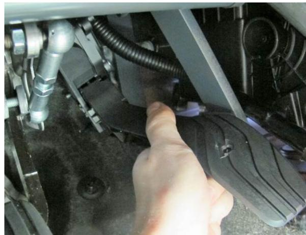
15. Die Strebe links von links an die Übertragung anlegen und vorn über den Stehbolzen an der Kupplungspedalkonsole schieben. Dann mit M 6 x 20 und Stopmmutter an der Übertragung und mit der Originalmutter am Stehbolzen verschrauben.
