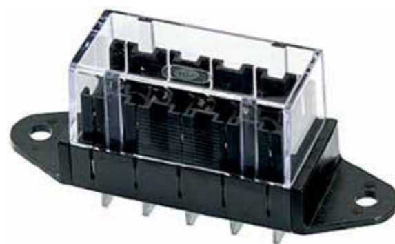
Säkringsdosa 5-polig 5-polig dosa med lock. Lodrät flatstift- eller krets-kortsanslutning. Artikel nr. Benämning 8JD 005 993 001 Med flatstift (max.30A) 8JD 005 993 021 För krets-kort (Max.15A)
