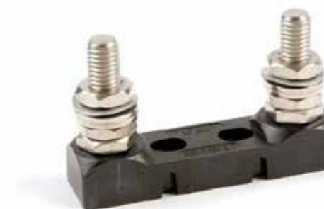
Säkringshållare för 60mm säkringsbleck För 60 mm säkringsbleck. Extra långa fästskruvar. Max. 425A. 80V Artikel nr. Benämning P 177 5721 0001 Säkringshållare
