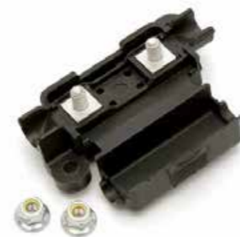
Säkringshållare för säkringsbleck För 30 mm säkringsbleck. Max. 16mm 2 kabel. Max. 150A. 80V Artikel nr. Benämning P 275 5640 0072 Säkringshållare
