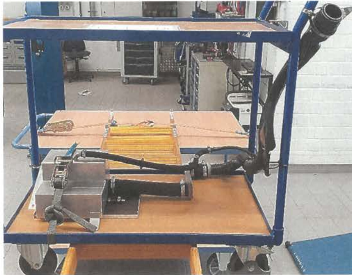
Kraftstoffbehälter mit Einfüllstutzen und Verschluss in Prüfeinrichtung
