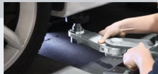
Possibilità di utilizzare il braccio in modalità standard o inclinato fino a 90°.
