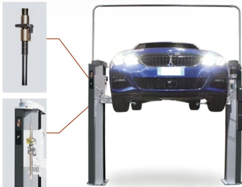
Il movimento del carrello è assicurato da una vite in acciaio rullato ed una busta in bronzo con lubrificazione automatica; elementi ad alta resistenza atti ad assicurare la massima sicurezza e la durata nel tempo.
